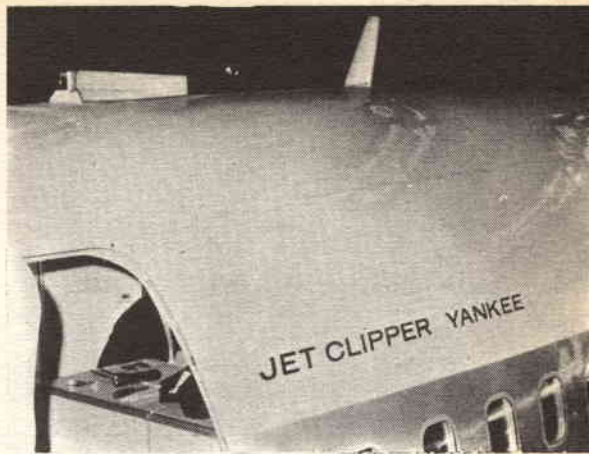
Per localizzare i CAT, l'elemento sensibile infrarosso dello IRCAT della Barnes è montato sopra un aereo della Pan Am. Finora, sembra che i dati raccolti siano buoni, pur con molte limitazioni.
