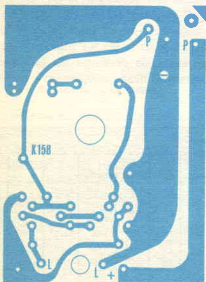
Fig. 3 - Illustrazione del circuito stampato, in grandezza naturale.
